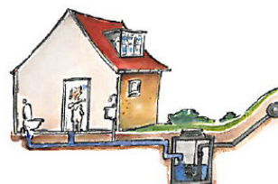
Eksempel på pumpebrønd
